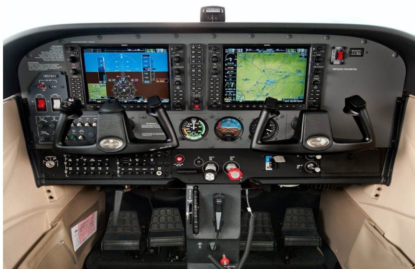
Figura 7: Cockpit de um Cessna 172 Skyhawk
