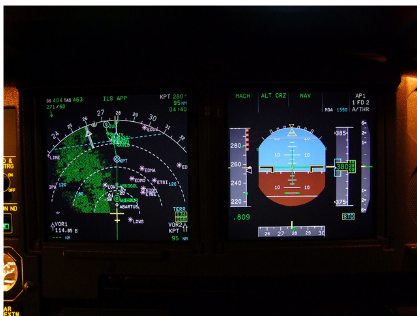
Figura 12: PFD e ND do Airbus
